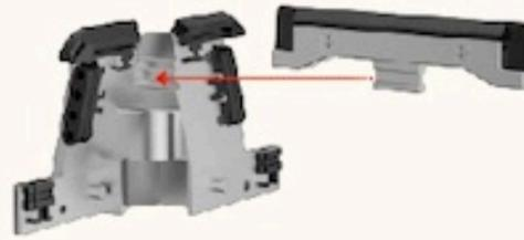
5. Nehmen Sie die bereits installierte Querstrebe und die halbe Gehäuseeinheit heraus.
