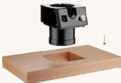
1. Die Haupteinheit in die Arbeitsplatte einbetten, mit einer Öffnungsgröße von 139 mm Länge und 154 mm Breite.
